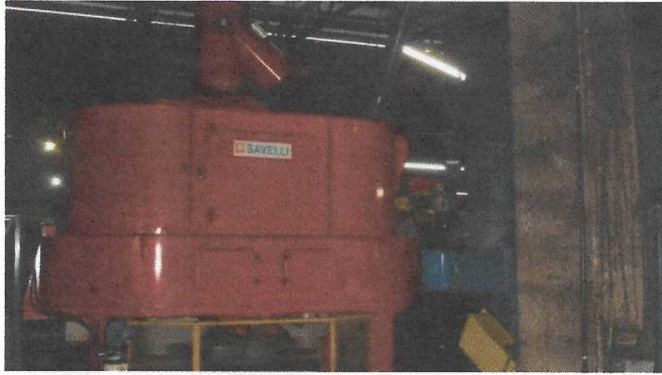
Resfriador de areia
